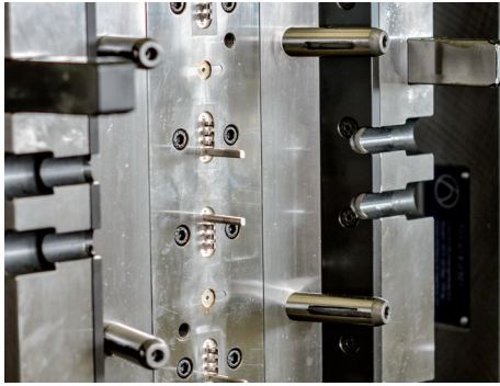
8-faches Spritzgießwerkzeug Größe: 650 mm x 350 mm
