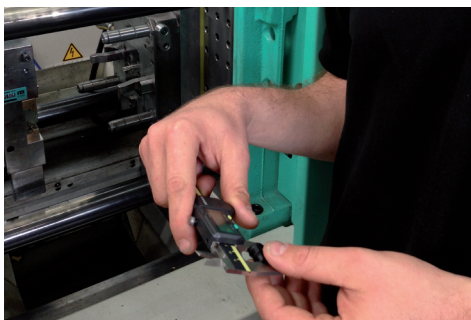
Bemusterung eines Steckverbinders zur anschließenden Werkzeugoptimierung
