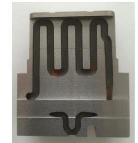
b) Konturnahe Kühlkerne realisiert mit Lasersintertechnik - Artikel: Steckverbinderleiste
