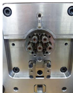
a) Konturnahe Kühldome realisiert mit Kupferstiften - Spritzguss E-Mobility-Steckverbinder
